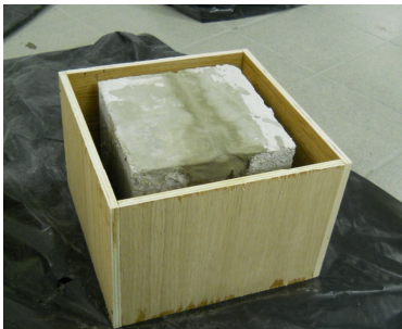
Incarniciatura con malta strutturale
