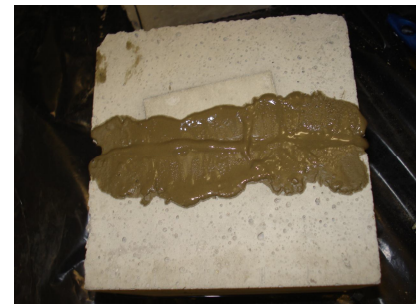
Riempimento fessura con Penetron Standard
